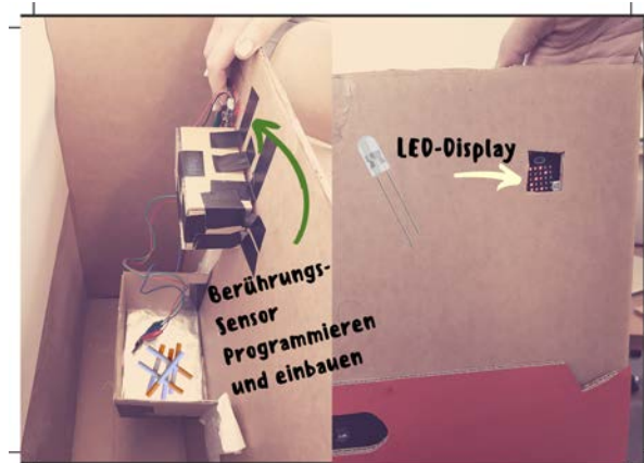
Abbildung 60 - Team «Zicasino» während der Umsetzungsphase: Sensoren und Technik einbauen
